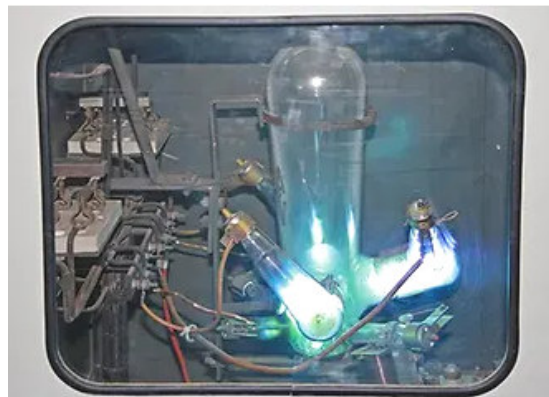
Der Quecksilberdampfgleichrichter - Ein Highlight im Ausstellungskomplex Gleichspannung
